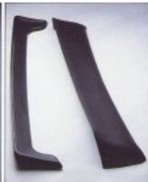
HECKSPOILER. Der linke Spoiler wird an der Heckklappe montiert, und der rechte ist für den Saab 99 vorgesehen.
