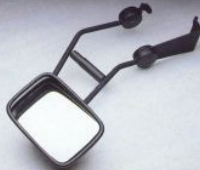
CARAVANSPIEGEL. Wird am Radkasten festgespannt und kann entweder elektrisch oder manuell verstellt werden. Diebstahlsicherung durch die Motorhaube.
