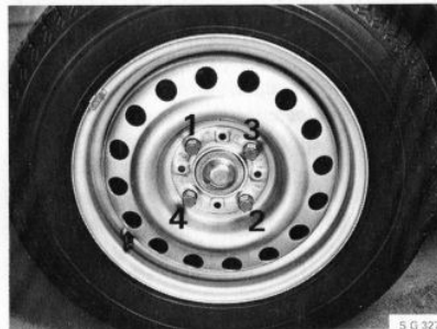
Volgorde vastdraaien van wielmoeren
