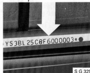
Het chassisnummer ingestanst in de carrosserie (in de achterste balk onder het deksel in de kofferruimte)
