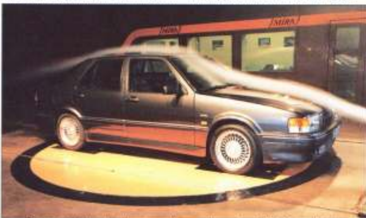
De aerodynamische eigenschappen van de accessoires worden in de windtunnel getest.
