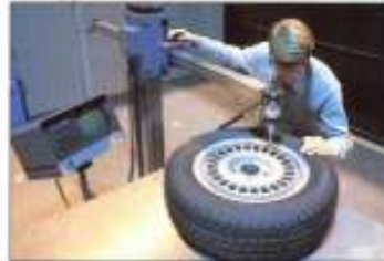
De krachten die nieuwe velgen tijdens hun tests ondergaan zijn sterker dan ze in werkelijkheid zullen ondervinden.
