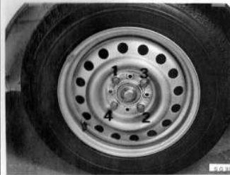
Volgorde vastdraaien van wielmoeren
