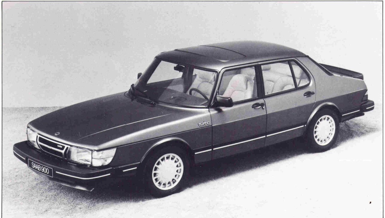
De 900 turbo, met twee kleppen per cilinder en een turbocompressor met een kracht van 145 pk.
