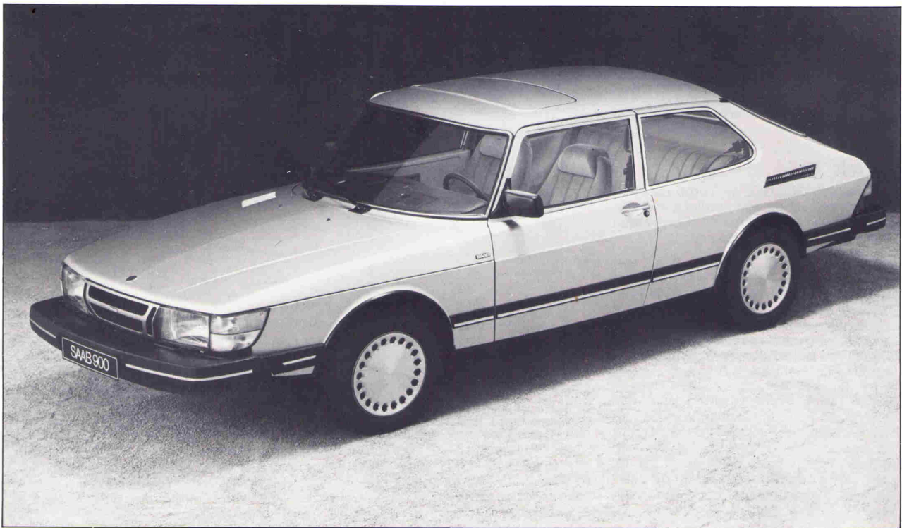
De Saab 900 i is voorzien van een injectiemotor, die 118 pk haalt.
