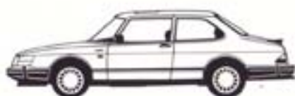
Saab 900 Turbo 2-deurs, 5 versnellingen acc. 0-100 km/u 8,9 sec Topsnelheid 195 km/u
