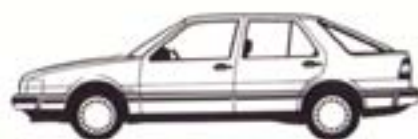
Saab 9000i 16 5-deurs, 5 versnellingen acc. 0-100 km/u 10,5 sec. Topsnelheid 190 km/u
