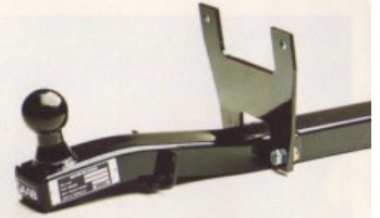
TREKHAKEN. U kunt kiezen tussen inschuifbare en vaste trekhaken. Beide soorten zijn getest en goedgekeurd voor Saab 90.
