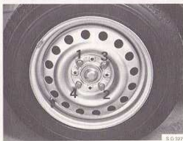
Volgorde vastdraaien van wielmoeren
