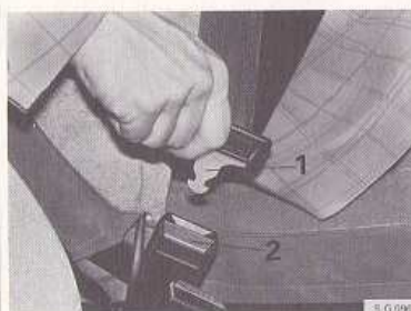
Veiligheidsgordel, voorstoel 1. Gesp. 2. Ontgrendelingsdruknop.
